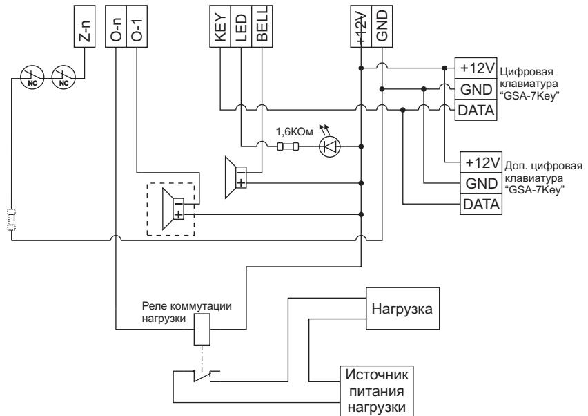
Цепь последовательно подключенных датчиков с контактами NC.
